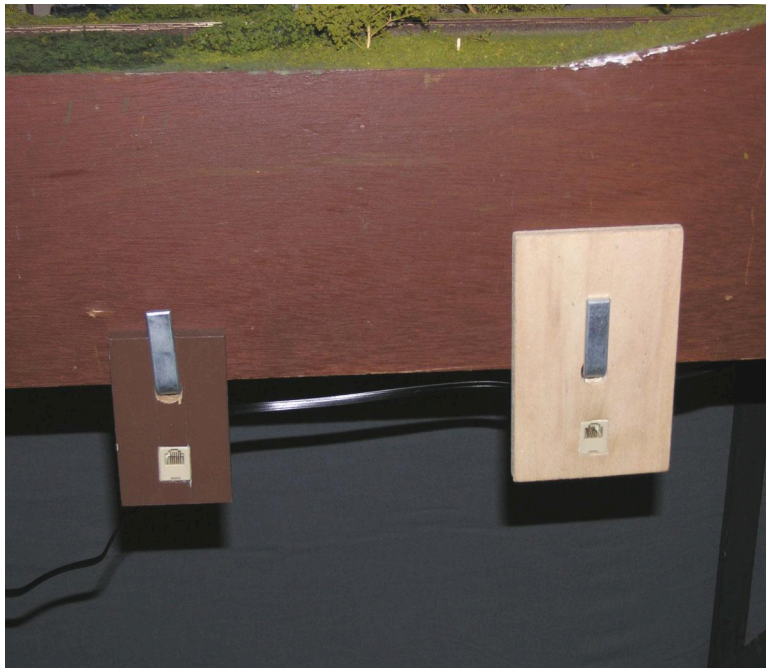
Abbildung 7: Angeschraubte Steckdosen für Regler
